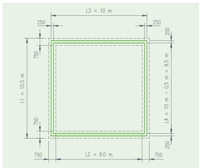
FIGURE 1 Dimension du mur (vue en plan)
