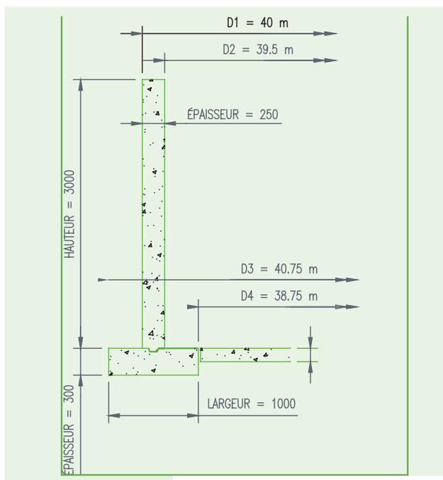
FIGURE 5 Réservoir à lisier circulaire
