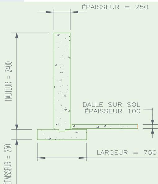
FIGURE 2 Dimension de la semelle et du mur (vue en coupe)
