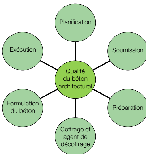
FIGURE 3 Facteurs afin d'assurer la réussite d'un béton architectural (3)
