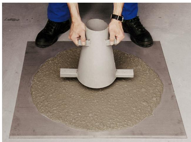
**FIGURE 12** Béton auto-plaçant
