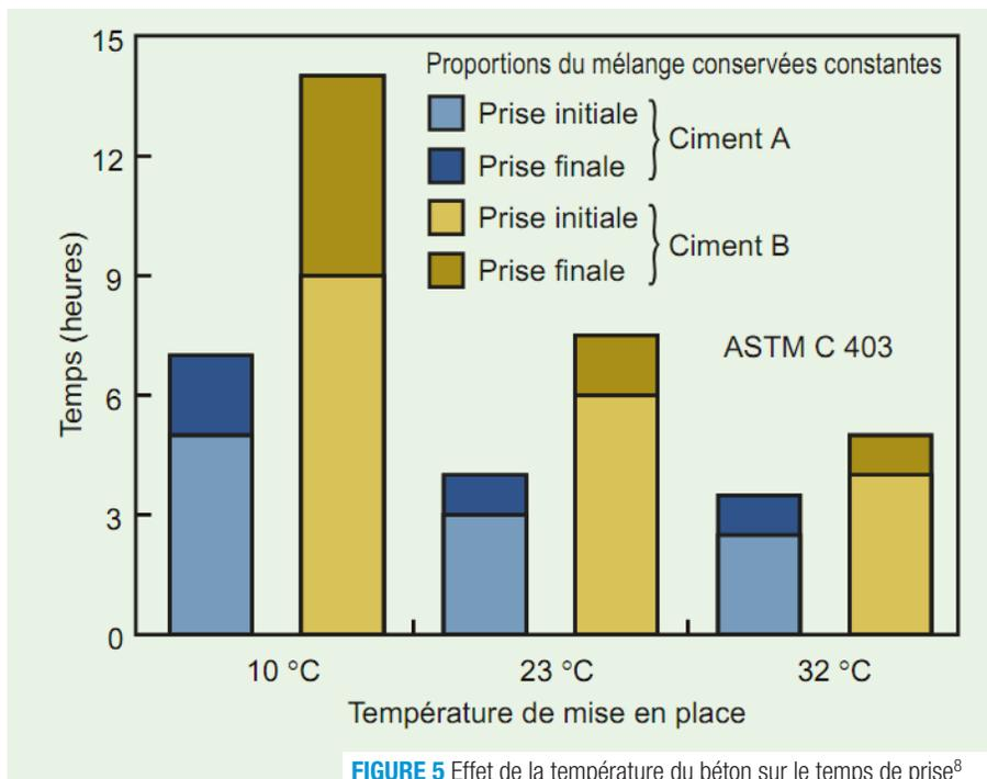
FIGURE 5 Effet de la température du béton sur le temps de prise<sup>8</sup>
