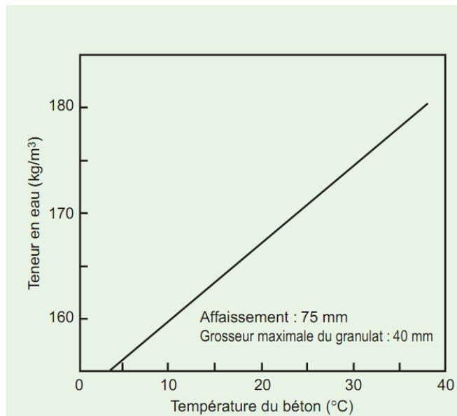
FIGURE 1 Influence de la température sur la quantité d'eau de gâchage<sup>2</sup>
